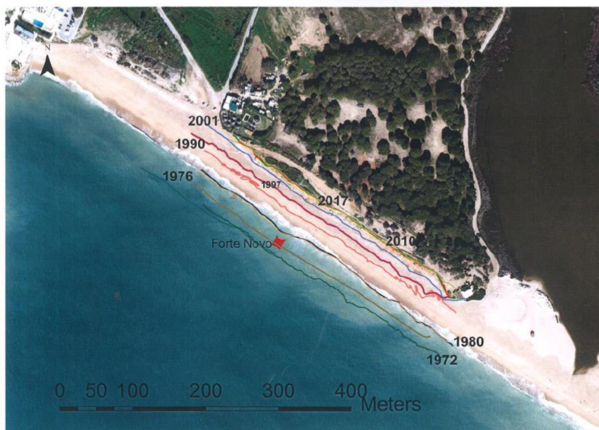
Figura 4.7 – Evolução espacial da crista da arriba no Forte Novo, entre 1972 e 2017 (base ortofoto de 2014) (Fonte: projeto de Execução, APA, 2020)
