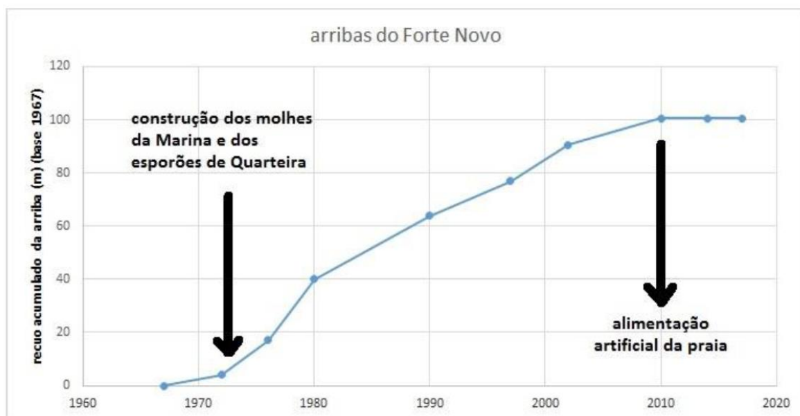
Figura 4.8 – Efeito das intervenções no recuo das arribas do Forte Novo (1967-2017) (Fonte: projeto de Execução, APA, 2020)
